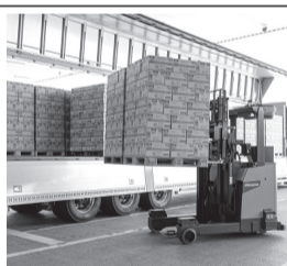
コカ・コーラ ボトラーズジャパンと豊田自動織機によるトラック荷役対応自動運転フォークリフトの実験の様子。
